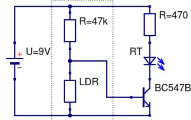
Wenn Sie nach einem Funktionstest die rote LED durch die LED WS austauschen, haben Sie eine helle Taschenlampe, die im Dunkeln automatisch angeht.
