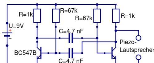
Wir können in unserer Blinker-Schaltung die Blinkfrequenz erhöhen, indem wir immer kleinere Kapazitäten verwenden. Die seitliche Schaltung zeigt, wie wir das Umschalten der Transistoren hörbar machen können - wir erhalten einen Tongenerator.
