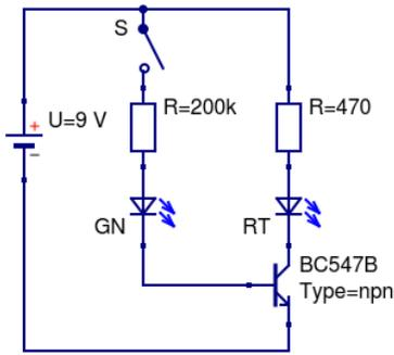
In der Schaltung fließt ein sehr(!) kleiner Basisstrom. Mit ihm steuern Sie den vielhundertfach größeren Kollektorstrom. Sie erkennen dies an der Helligkeit der LEDs.
