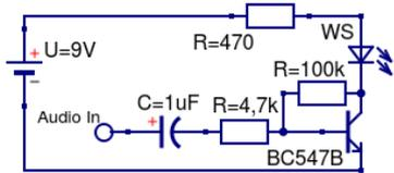
Ton und Musik lassen sich auch durch Licht übertragen. Dazu verwendet man eine helle LED, die ihre Helligkeit entsprechend des Audiosignals variiert. Und das erreicht man durch die linke Schaltung:
