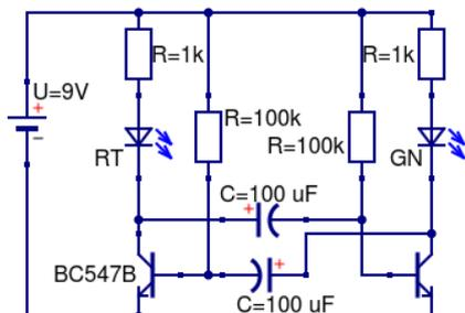
Die seitliche Schaltung befindet sich so oder ähnlich aufgebaut in jedem Auto: Abwechselnd blinken die rote und die grüne LED. Man bezeichnet die Schaltung als astabilen Multivibrator.
