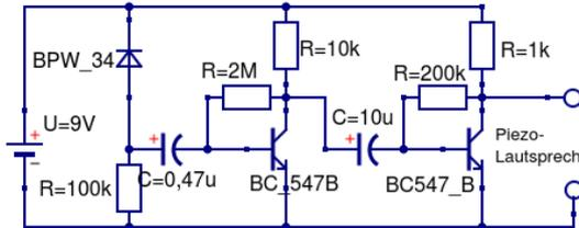
Für den Empfänger des Lichtsignals benötigen wir eine besonders große Verstärkung, um ausreichende Reichweiten zu erzielen. Für große Verstärkungen kann man mehrere Verstärkerstufen hintereinanderschalten. Dieser Empfänger enthält, wie man sofort sieht, zwei Verstärkerstufen.
