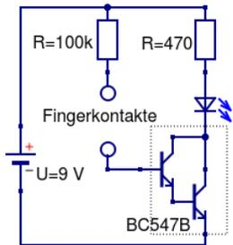
Jetzt lassen wir STROM durch unseren Körper fließen! Die Ströme sind bei 9V natürlich sehr klein... Wie lassen sich die winzigen, bei 9V über uns fließenden Ströme so stark verstärken, dass man LEDs damit schalten kann? - Diese Schaltung gibt eine Antwort darauf:
