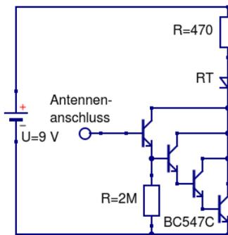
Bei einem Kabelfinder nutzt man aus, dass unser Stromnetz mit Wechselstrom gespeißt wird. Das heißt, die Stromkabel in unserem Haus wechseln 100 mal in der Sekunde die Polarität.
